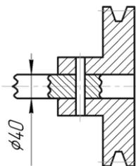
Определить диаметр болтов (число болтов 4) поперечно-свертной муфты для передачи мощности  $P = 4,2 \text{ кВт}$  с частотой вращения  $n = 800 \text{ об/мин}$ . Болты установлены без зазора, допускаемое напряжение
