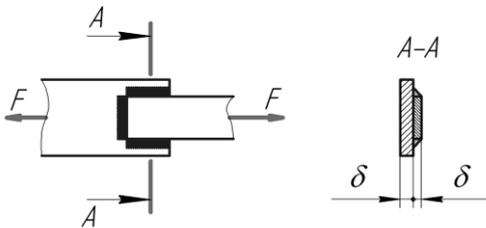
Рычаг 1 крепится к фланцу 2 двумя заклепками. Определить диаметр заклепок, если нагрузка
