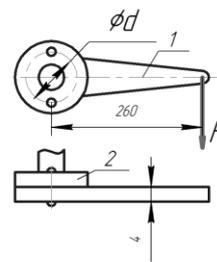
Определить диаметр болтов крепления стойки корпуса плуга к раме, считая что сила сопротивления  $F = 5,4 \text{ кН}$  приложена в точке "А".  $a = 60 \text{ мм}$ .
