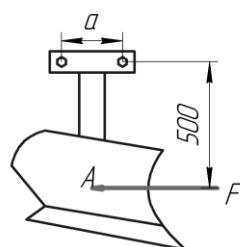
Рычаг 1 крепиться к фланцу 2 двумя заклепками. Определить диаметр заклепок, если нагрузка
