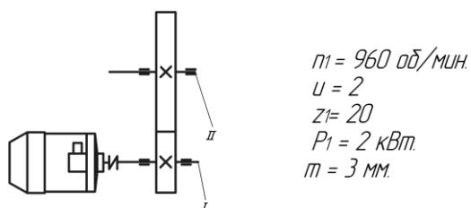
Определить усилия действующие на ведомый вал передачи показанной на схеме.
