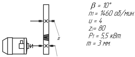
Определить размеры зубчатого колеса:
