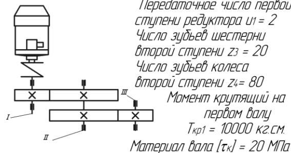
Определить ориентировочно диаметр ведомого вала:
