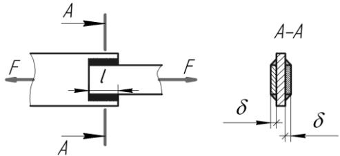
Определить общую длину шва в сварном соединении, если известно:
