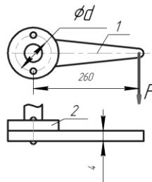
Сегмент режущего аппарата крепится к ножевой полосе двумя заклепками. Определить диаметр заклепок если:
