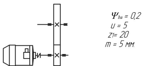
Определить размеры зубчатого колеса:
